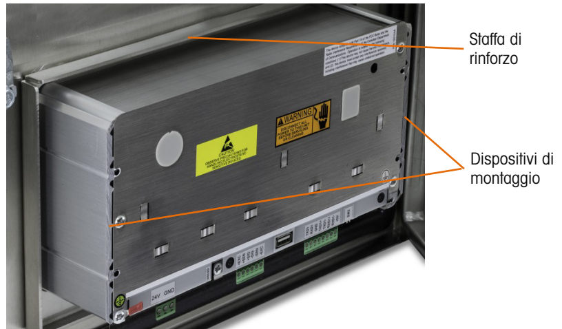
Figura 2-6: Staffa di rinforzo per pannello installata
