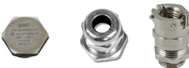
Figura 2-3: Tapón y casquillo "e" de seguridad incrementada y casquillo POWERCELL, certificados por ATEX/IECEx
