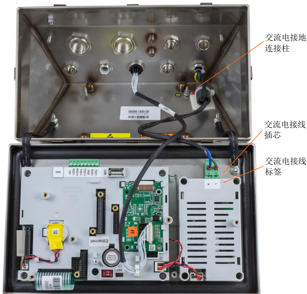
图 A-26: 防尘式型号上的交流电连接
