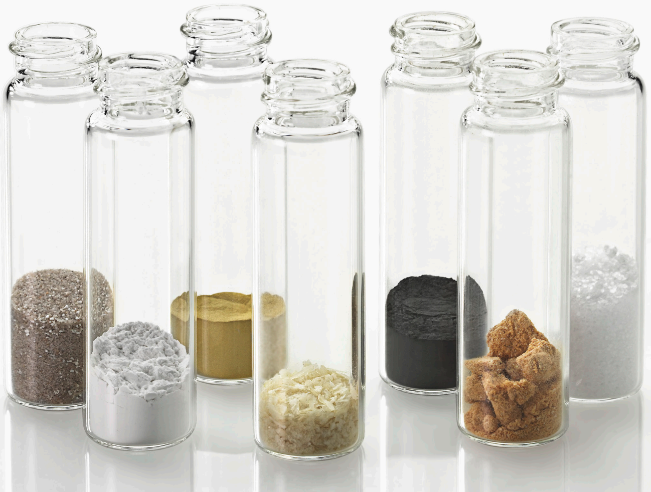
粉末呈现各种特点；颗粒的大小、形状、表面质地和密度各不相同。这导致粉末特性不同。
