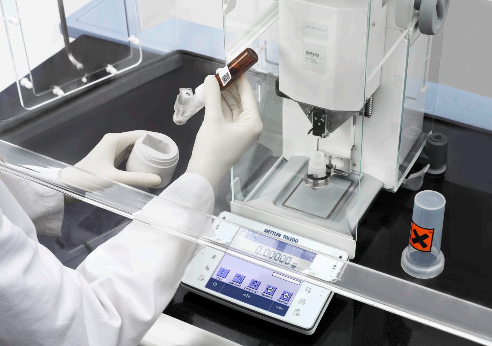
Quantos 自动化粉末定量加样系统保护用户避免接触强效物质。
