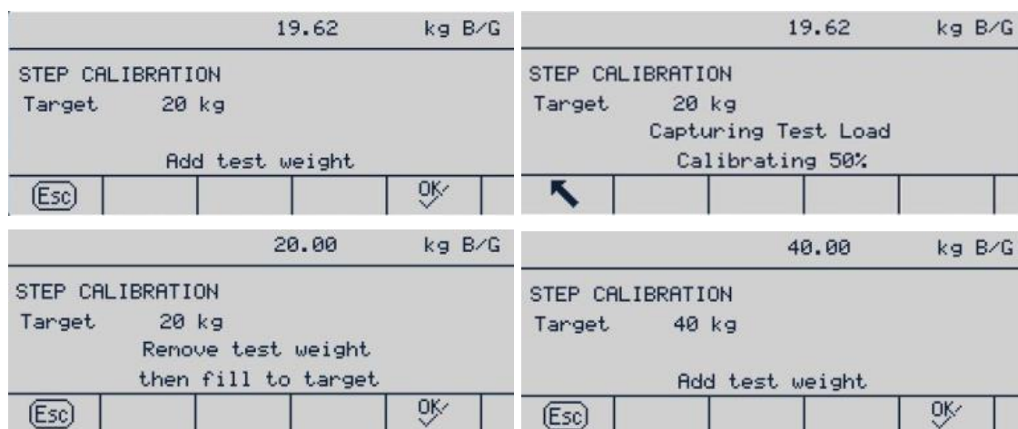
Figure 3-23 : Étalonnage par étape en cours
