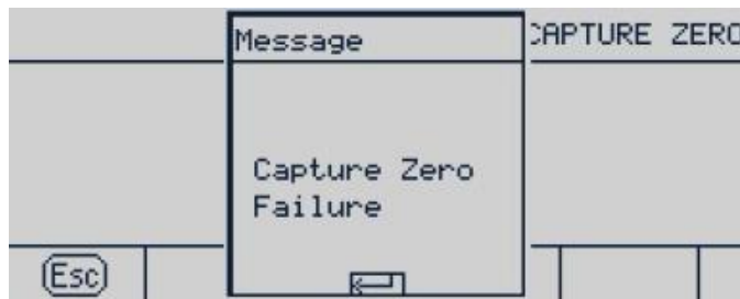
Figure 3-13 : Étalonnage du zéro (échec)
