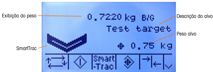
Figura 2-19: Exibição de excesso/falta, médio
