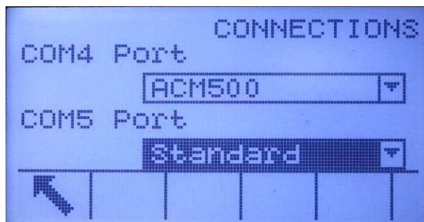
Figura 3-14: Conexão COM4 ou COM5 configurada para o conversor de fibra óptica ou o ACM200
