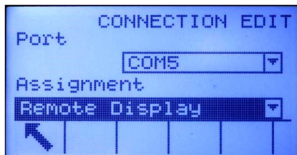
Figura 3-15: Conexão COM4 ou COM5 configurada para operação remota
