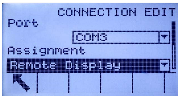
Figura 3-13: Conexão COM2/COM3 configurada para operação remota
