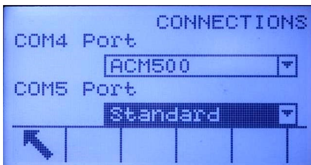
Figura 3-12: Conexão COM4 configurada para ACM500
