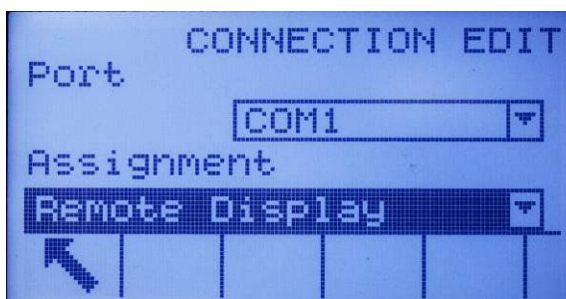
Figura 3-11: Conexão COM1 configurada para operação remota
