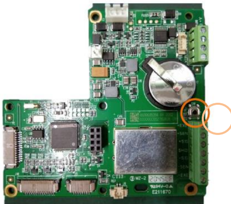
仪表主板上的计量设置开关位置
