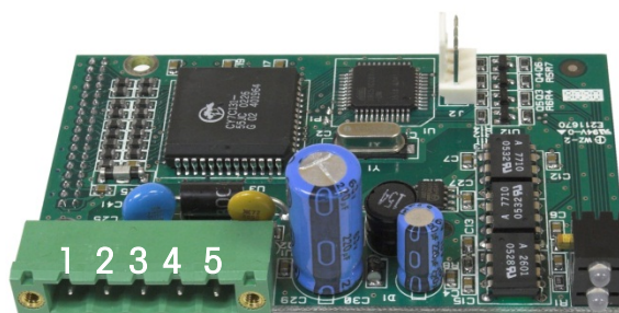
Figura 2-103: Numeración de patillas de la tarjeta opcional DeviceNet
