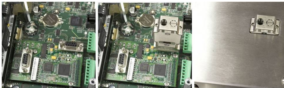
Figura 2-110: Conector do Módulo CLP Profibus para gabinete montado em painel
