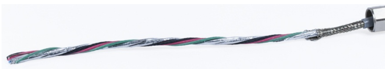
Figure 2-58 : Découpe de la gaine intérieure
