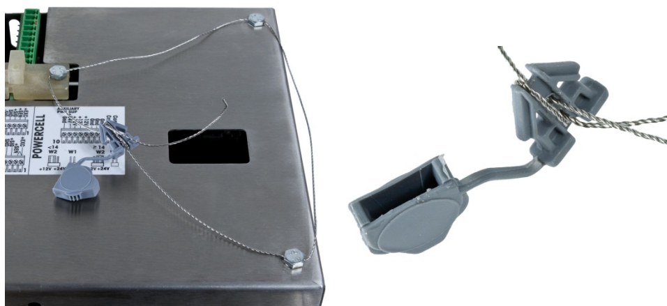
Abbildung 2-117: Eingesetzter Plombendraht, Plombendraht durch die Plombe durchgeführt
