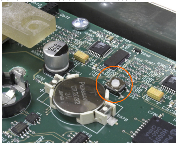
Figura 2-38: Ubicación del botón principal de reinicialización del PCB principal
