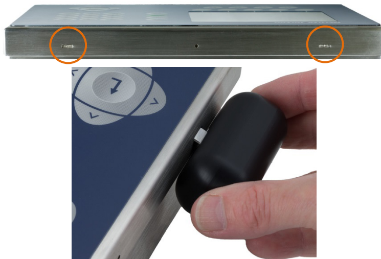
Figura 2-2: Apertura dell'armadietto per ambienti gravosi, metodo preferito
