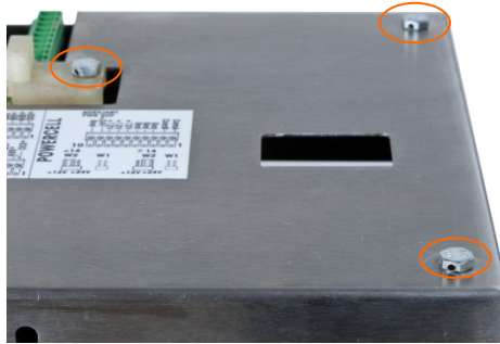
Figure 2-116: Couvercle du panneau arrière de l'enceinte avec les vis de plombage installées
