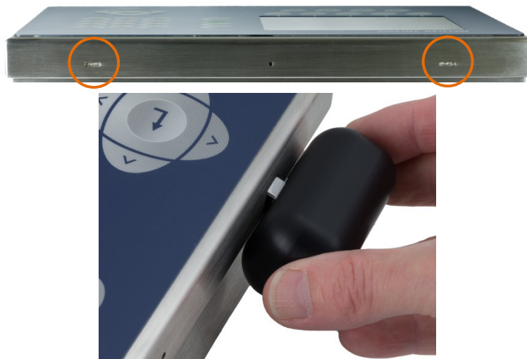
Figura 2-2: Abertura do Gabinete para ambiente adverso, Método Preferido
