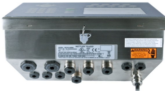
Figura 2-123: Armadietto per ambienti difficili, sigillatura completata
