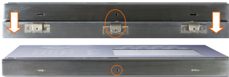
Figure 2-120: Emplacement de plombage à l'arrière du panneau avant
