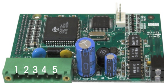
Figure 2-103: Carte d'option DeviceNet numérotage des broches
