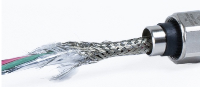
Figura 2-59: Forro interno deshilachado
