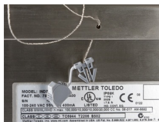
Figure 2-121: Fil de plombage enfilé à travers le couvercle et l'attache
