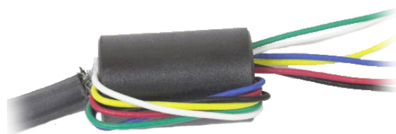
Figure 2-19: Tore de ferrite sur le câble d'un capteur analogique
