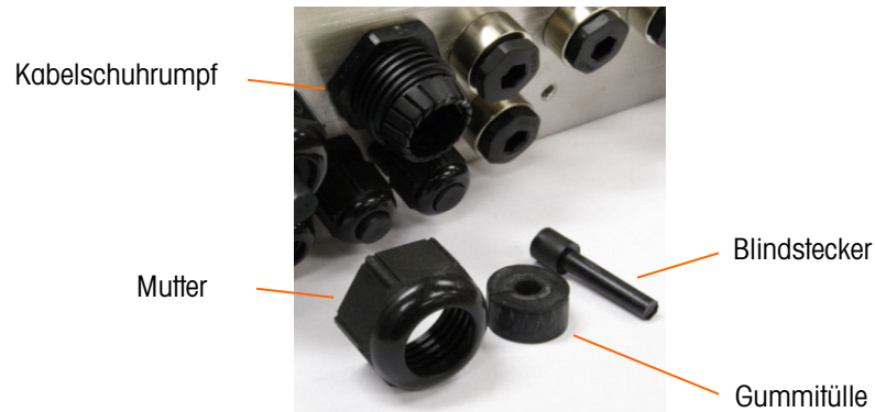
Abbildung 2-25: Kabelstutzenkomponenten
