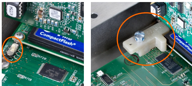
Figura 2-113: interruttore di sicurezza metrologica (a sinistra) e coperchio installato (a destra)
