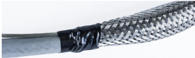
Figure 2-54 : Gaine externe fixe avec du ruban isolant
