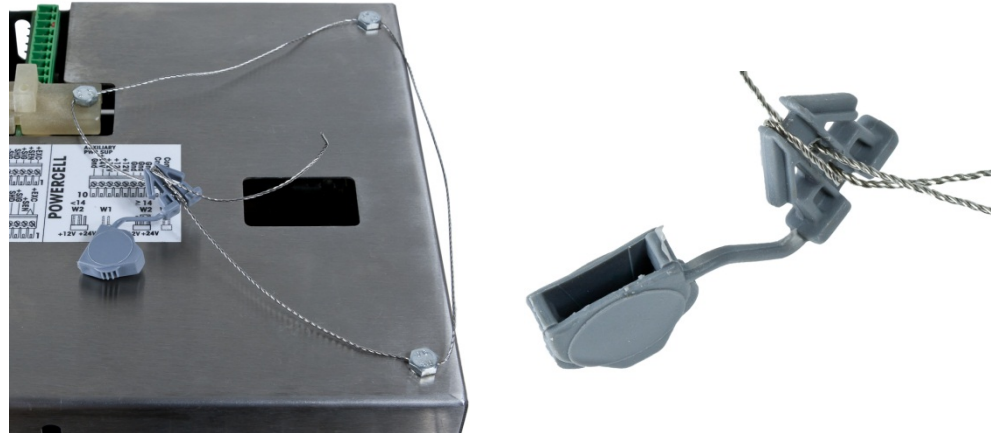
Figura 2-117: Alambre de sello instalado, alambre insertado a través del sello
