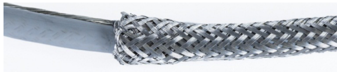
Figura 2-55: Forro externo empujado sobre el extremo con cinta
