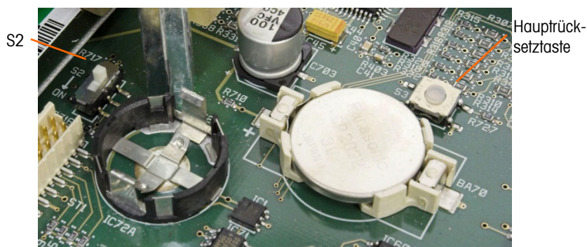
Abbildung 2-38: Position der Hauptrücksetztaste auf der Hauptplatine
