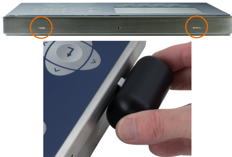
Abbildung 2-2: Öffnen des Gehäuses für raue Umgebungen (bevorzugte Methode)
