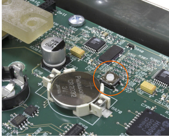
Figura 2-38: Localização do Botão Redefinição Mestre da Placa Principal
