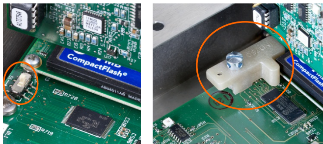
Abbildung 2-113: Metrologie-Sicherheitsschalter (links) und installierte Abdeckung (rechts)
