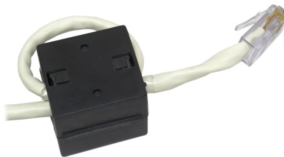
Figura 2-20: Instalación de la ferrita de abrazadera
