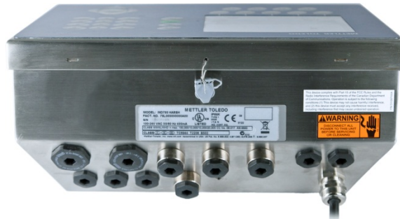
Abbildung 2-123: Gehäuse für raue Umgebung, Plombe angelegt
