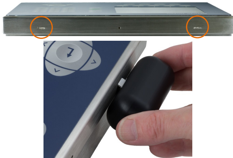
Figure 2-2: Ouverture de l'enceinte pour environnement difficile, méthode préférée
