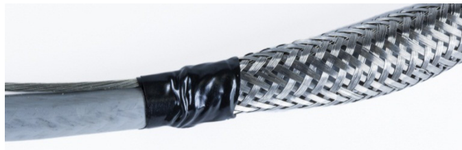
Figura 2-54: Forro externo inmovilizado con cinta eléctrica
