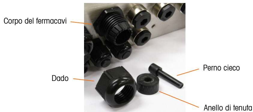
Figura 2-25: Componenti pressacavi
