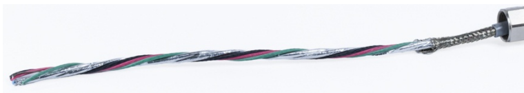
Abbildung 2-58: Zurückgeschnittener innerer Kabelmantel
