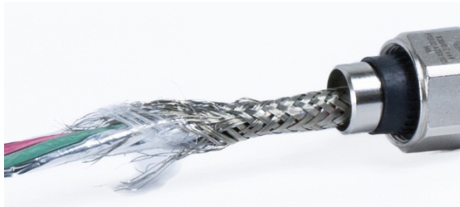
Figure 2-59 : Gaine interne effilochée
