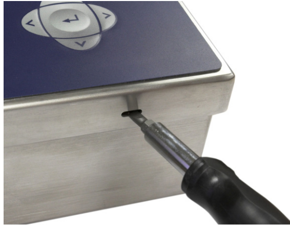
Abbildung 2-4: Öffnen des Gehäuses für raue Umgebungen (Alternative Methode)
