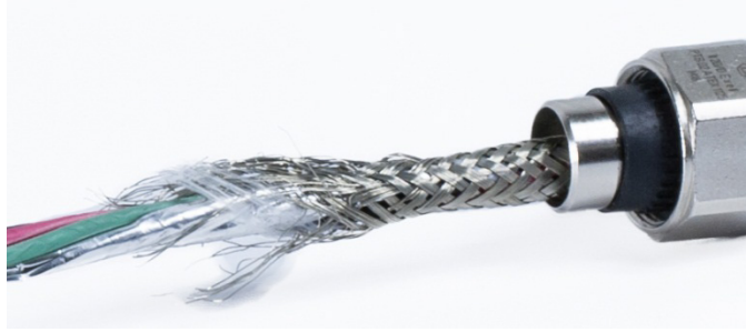
Abbildung 2-59: Ausgefransteter innerer Kabelmantel
