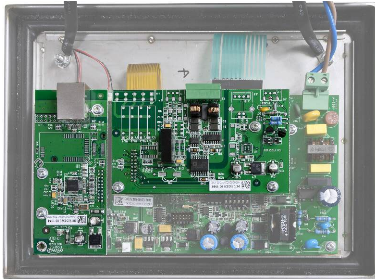
Figura A-59: Ubicaciones de las tarjetas opcionales
