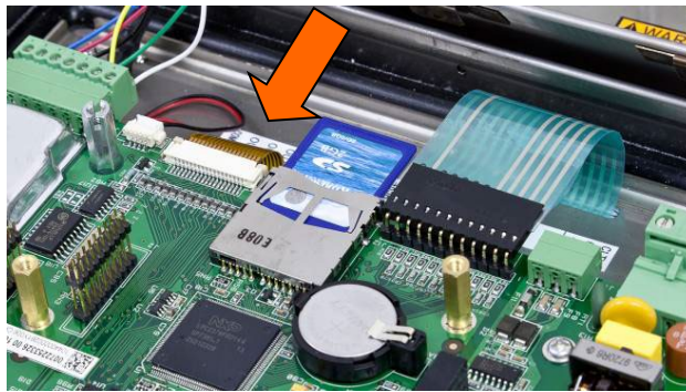
Figura 5-14: Inserción de la tarjeta de memoria SD
