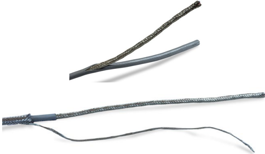
Figura A-35: Separación del forro del cable de la protección trenzada interna
