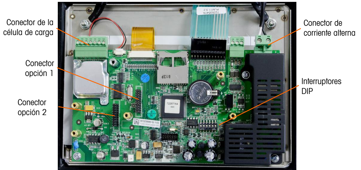
Figura A-19: Conexiones de la tarjeta principal del IND246, modelo para corriente alterna
