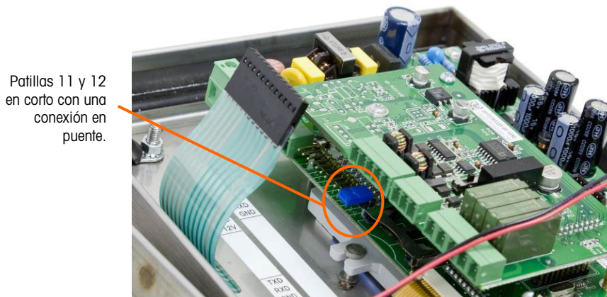
Figura 5-4: Prueba de conexión en puente para la tecla de encendido y apagado
