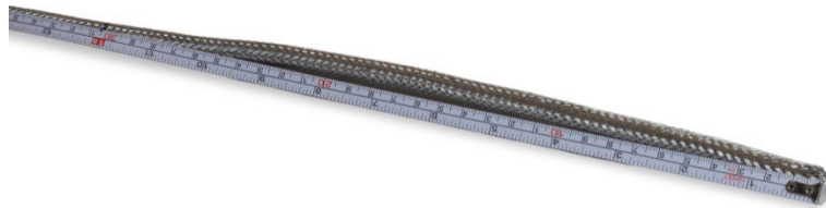
Figura A-29: Medición del blindaje trenzado exterior antes del corte
