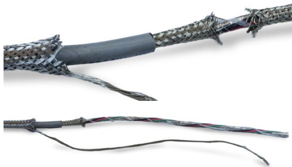
Figura A-37: Retiro de la protección trenzada interna
