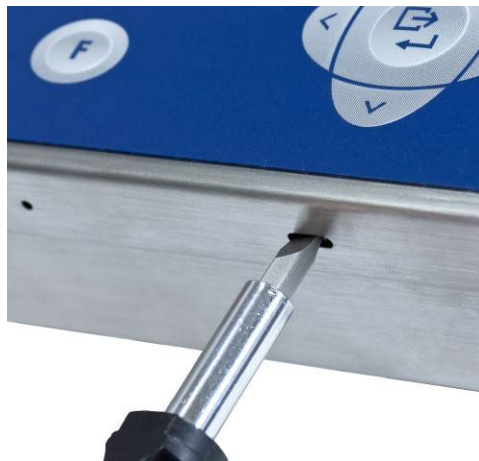
Figura A-1: Apertura de la caja para ambientes adversos
