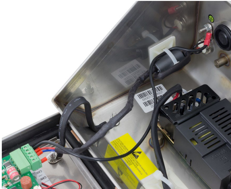
Figura A-56: Conector de PowerDeck instalado en el IND246 POWERCELL
