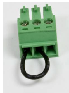
Figura 5-11: Cable de puente entre los terminales de transmisión y recepción COM1
