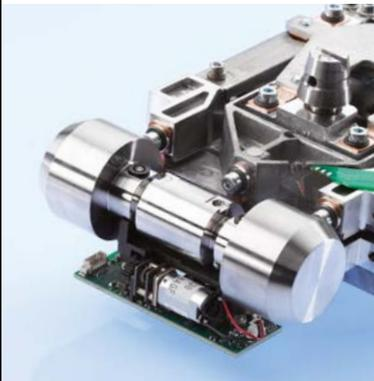
完美的称量技术确保稳定与精确的称量结果。
